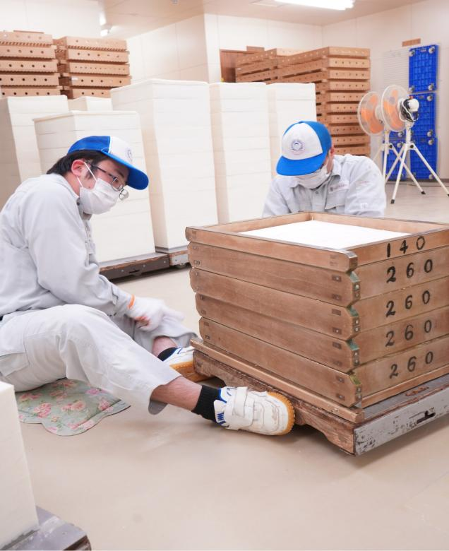
「段切り」と呼ばれる製造工程。固まった石鹼ブロックに木枠をはめ、ピアノ線を使って2人がかりで切り出す。息が合わないときれいに切り出せない。リズムよく軽快に作業しているように見えても、実際はなかなか力が必要。切り出した板状の石鹼は、重ねて自然乾燥させる。
