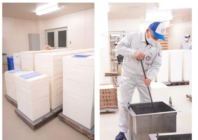
右/型枠に流し込まれた石鹼成分は、手作業で攪拌、練り上げている。左/段切りを終えた板状の石鹼ブロック。1枚あたり約13キロにもなり、坊っちゃん石鹼（ピンクのパッケージ）66個分になる。このまま自然乾燥させ、棒切りの工程に進む。
